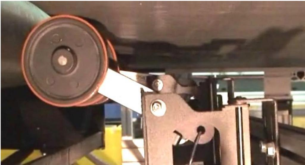
**Figure 90: Tachometer Wheel**
