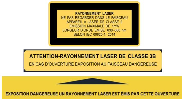
Figure 2: Exemple d'étiquettes d'avertissement laser
