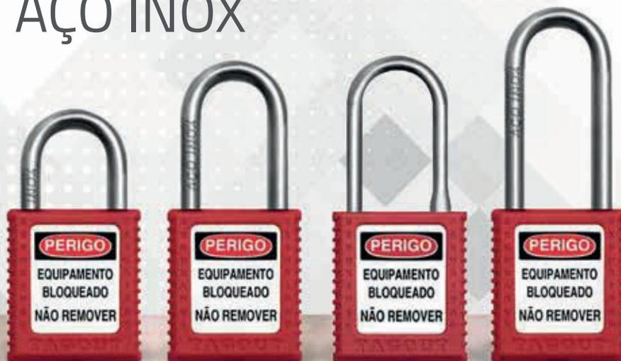
O **Cadeado de Bloqueio** é ideal para bloqueio em ambientes corrosivos, altamente agressivos. Corpo do cadeado resistente a corrosão, altas temperaturas e a produtos químicos. São eletricamente isolados, extremamente leves e podem ser usados nas diferentes áreas de sua empresa. Retêm a chave enquanto aberto para maior segurança, e possuem desenho com ranhuras para maior firmeza quando manuseado.
