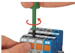
Terminação do condutor - etapa 1: Gire a ferramenta de operação (lâmina de largura 5,5 mm) no sentido anti-horário. Em seguida, empurre a aba de travamento laranja. A mola continua aberta e permite que as mãos fiquem livres para a operação.
