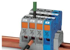
Terminação do condutor - etapa 2: Insira um condutor decapado na unidade de conexão, até atingir a parte traseira. Mantenha nessa posição.
