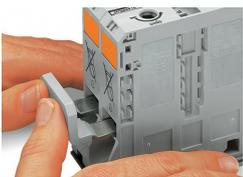
O jumpeamento com um jumper adjacente: insira o jumper acima do orifício de entrada do condutor antes da conexão do condutor. O corte transversal nominal permanece inalterada.
