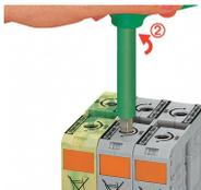
Terminação do condutor - etapa 3: Uma pequena rotação no sentido anti-horário libera a lingueta. Quando destravada, a chave de torque gira no sentido horário, fixando o condutor com segurança.
