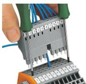
Módulos de plugue de teste tipo L equipados com CAGE CLAMP®
