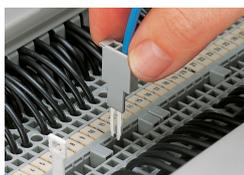
Testando com conector de teste. A imagem mostra um plugue de teste equipado com CAGE CLAMP®.
