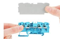
Separador para aplicações Ex e/Ex i Uma tampa final deve ser utilizada no borne localizado diretamente atrás de um separador Ex e/Ex i.
