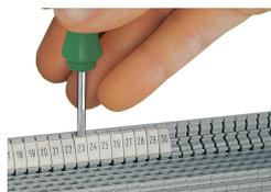
Encaixe uma tira de marcador WMB no slot de marcador do suporte de marcador duplo.
