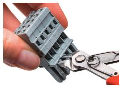
Codificação de um conector fêmea pela remoção dos pinos de codificação com ferramenta de corte. Não remova o primeiro e o último pino de codificação ou use uma alavancas de bloqueio adicional.
