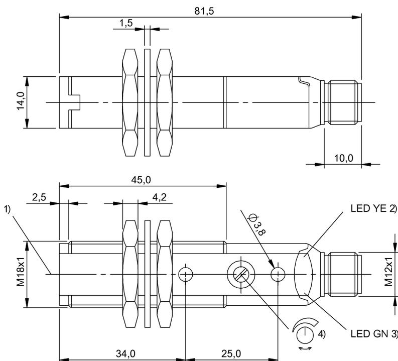
1) Eixo ótico, 2) Função de saída, 3) Estabilidade, 4) Sn
