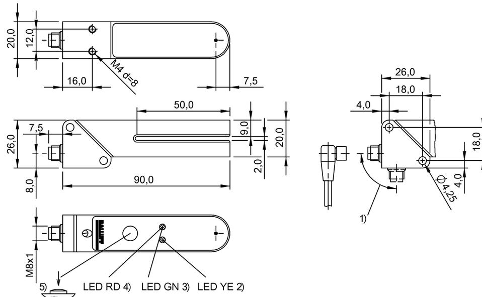
1) Giratório em 180°, 2) Função de saída, 3) Estabilidade/erro, 4) Falha/curto-circuito/erro, 5) Sensibilidade, claro/escuro
