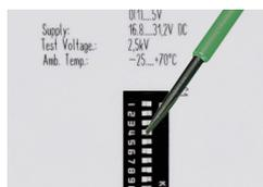
Configuração através de Interruptor DIP.
