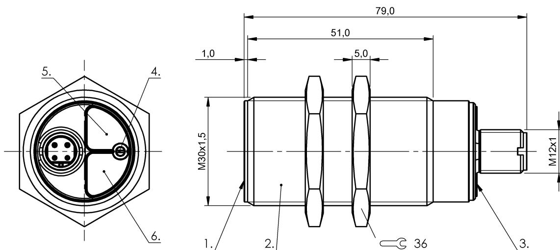
1) Superfície ativa, 2) Invólucro, 3) Tampa, 4) Potenciômetro, 5) LED da tensão de serviço, 6) LED do indicador de funcionamento
