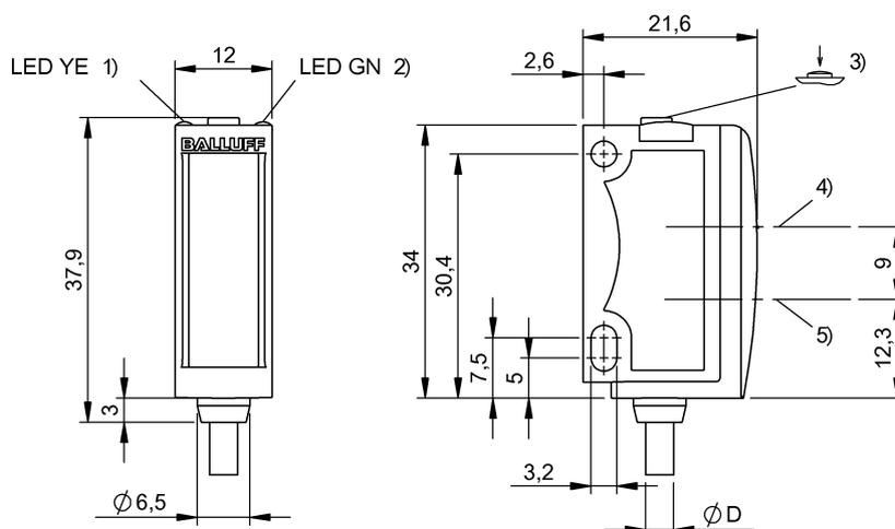
1) Função de saída, 2) Tensão de serviço, 3) Sensibilidade, claro/escuro, 4) Eixo ótico do receptor, 5) Eixo ótico do transmissor
