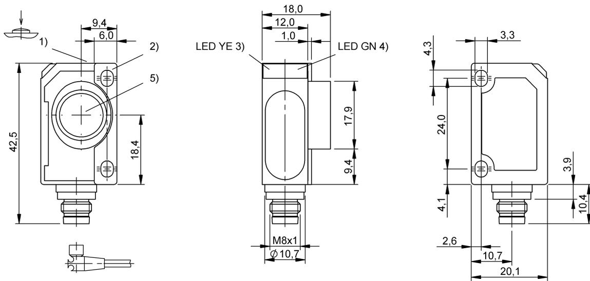
1) Ajustar o sensor, 2) Placa de fixação, 3) Indicação de estado, 4) Tensão de serviço/modo de operação, 5) Eixo do conversor ultrassônico
