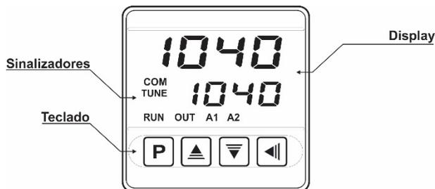
Fig. 02 - Identificação das partes do painel frontal
