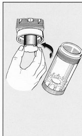
Para limpar ou substituir o elemento solta-se o grupo de centrifugação. Para desroscar o copo usar chave tipo compasso Ø 3.
