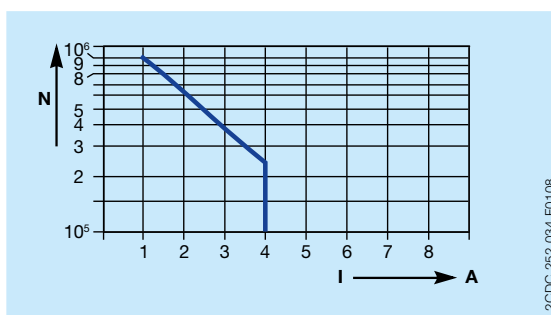
Kontaktlebensdauer / Schaltspiele N 220 V 50 Hz AC1, 360 Schaltungen/h
