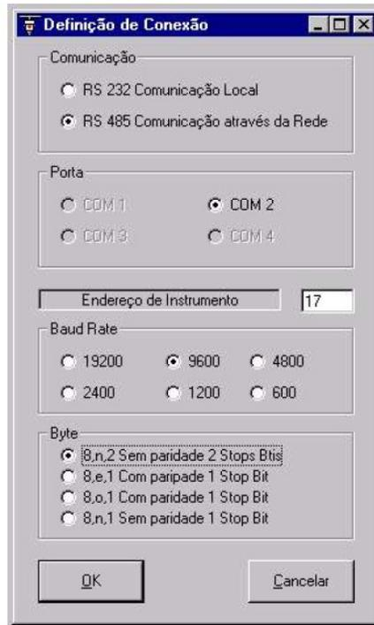
Figura 11 – Definição da Conexão
