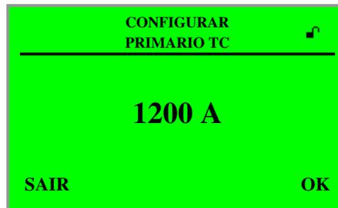
Figura 7 – Configurar Corrente Primária
