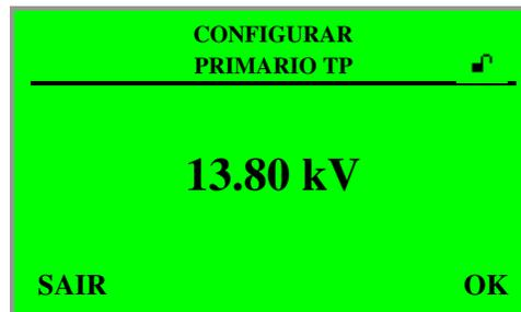
Figura 8 – Configurar Tensão Primária
