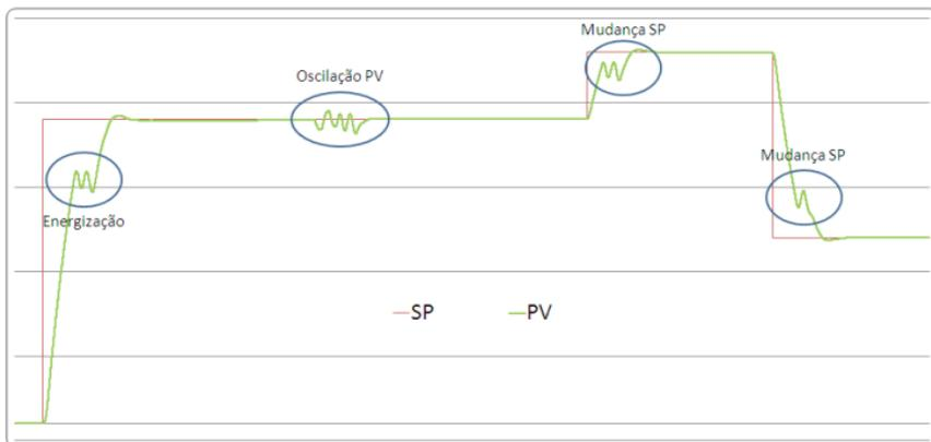
**OBS.:** Em processos nos quais a estrutura ou meio pouco se alteram, recomendamos utilizar a opção **A.t** que, uma vez sintonizada, não mais interfere na rotina do processo.
