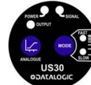
Il sensore può essere programmato sia tramite il pulsante ANALOG, sia tramite un comando remoto (remote teach). Il comando remoto (remote teach), permette inoltre di disabilitare il pulsante del sensore, per evitare programmazioni indesiderate da parte di personale non autorizzato. Per abilitare questa funzione è sufficiente collegare il filo di comando remoto a 0 Vdc, tramite un commutatore esterno.
