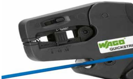
Corte do fio com o alicate 210-124 „Quickstrip 10“
