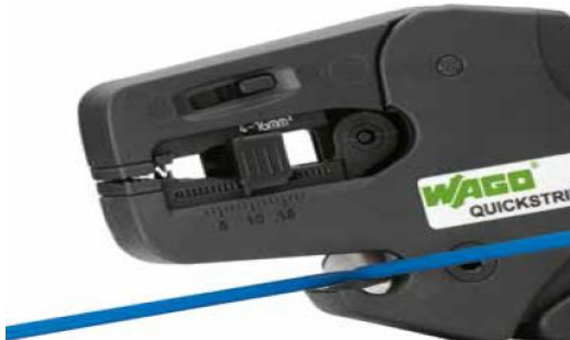
Corte do fio com o alicate 210-124 „Quickstrip 10“
