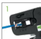
1 Decape o fio de 9 a 10mm, conforme o gabarito da peça (figura 2).
